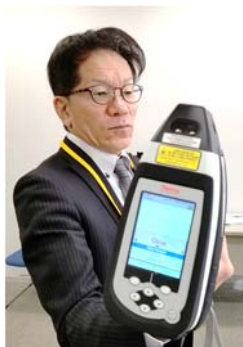
福岡労働局にて、白石綿(クリソタイル)の検出確認試験
